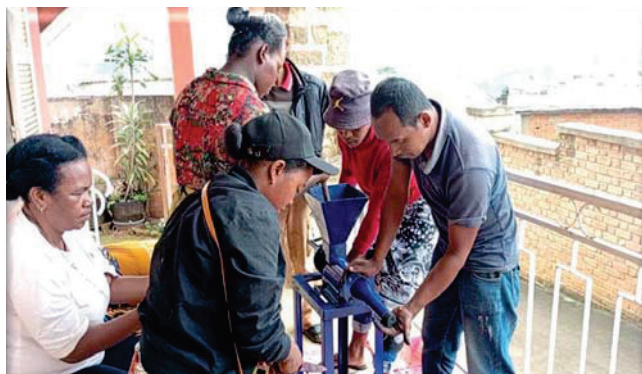
Anschaffung von mechanischen Pressen für die Herstellung von Ökokohle.
